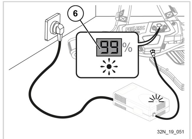
Une fois la batterie chargée, débrancher en premier le cordon de charge (1) au niveau de la batterie et ensuite la prise secteur du chargeur (2).
