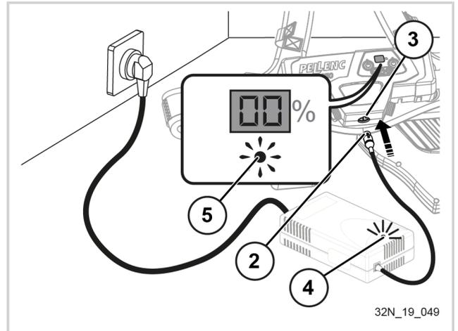
Quand l'afficheur jauge (6) clignote, la batterie est en charge. La charge est finie lorsque le message 99 fixe apparaît à l'afficheur jauge (6).
