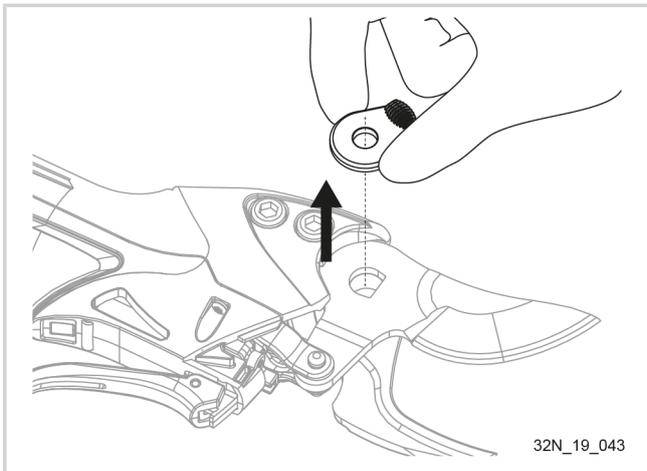
10. Remettre la lame sur le crochet après avoir graissé la portée puis remettre l'axe de lame et l'axe épaulé.
