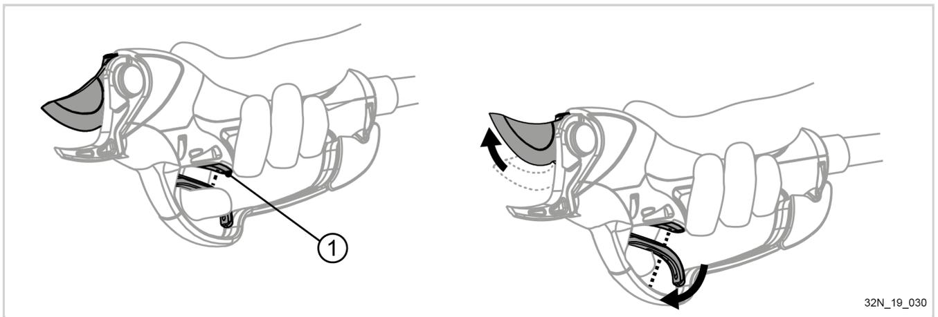
La lame reste en demi-ouverture tant que la système optique (1) détecte que votre doigt est sur la gâchette. Lorsque votre doigt lâche la gâchette, le système optique commande la pleine ouverture de la lame.
